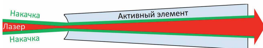
Изображен активный элемент и распространение пучков накачки и лазера в нем
