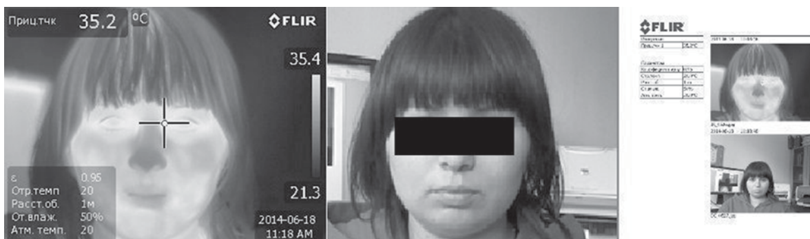
Рисунок 4 - Бесконтактное измерение температуры тела работника с помощью тепловизора Flir E60. Слева направо: экран прибора с изображением в ИК-диапазоне; снимок в видимой области спектра; пример выходного протокола измерения.
